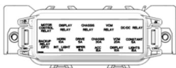
En cas de pannes électriques non reliées aux batteries, un fusible peut nécessiter un remplacement. Localiser et corriger tout court-circuit qui aurait pu causer le fusible sauté, ensuite remplacer le fusible. Consulter un concessionnaire agréé GEM si un relais ou une diode semble nécessiter un remplacement.
