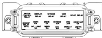
En cas de pannes électriques non reliées aux batteries, un fusible peut nécessiter un remplacement. Localiser et corriger tout court-circuit qui aurait pu causer le fusible sauté, ensuite remplacer le fusible. Consulter son concessionnaire agréé GEM si un relais ou une diode semble nécessiter un remplacement.
