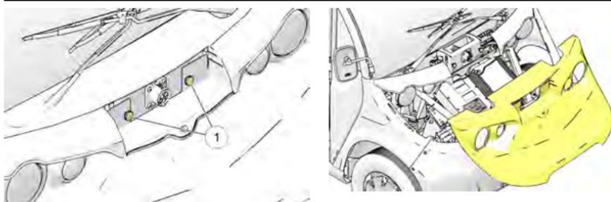
1. Retirer les deux vis du capot se trouvant sous la trappe de l'orifice de recharge. ①
