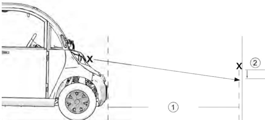
1. Garer le véhicule sur une surface de niveau, avec le phare à environ 7,6 m (25 pi) d'un mur ①.
