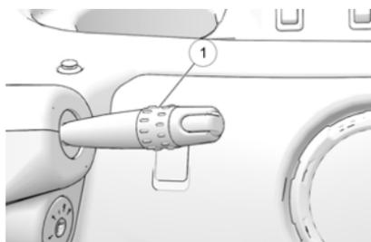
Si l'essuie-glace ne fonctionne pas, vérifier la présence d'un fusible grillé dans le bloc-fusibles. Consulter la page 70.
