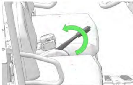
L'image de droite est un gros plan du levier de frein de stationnement qui a atteint sa position de butée dure à sa course maximale. Il s'agit aussi du point où le levier de frein de stationnement a engagé la dixième dent de verrouillage ce qui indique qu'il est nécessaire de procéder à un réglage. Cette image montre un frein de stationnement dont le soufflet de caoutchouc a été retiré.
