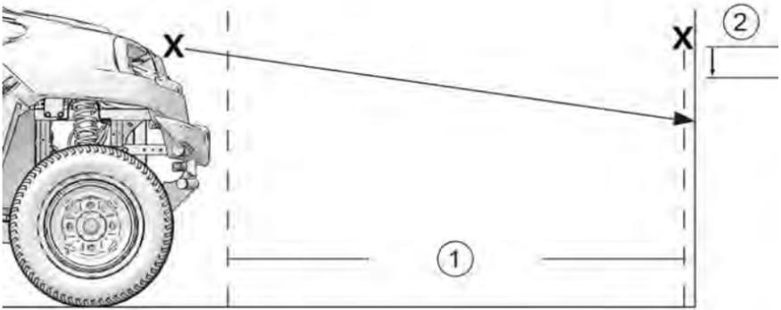
1. Garer le véhicule sur une surface de niveau, avec le phare à environ 7,6 m (25 pi) d'un mur ①.
