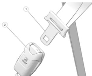
1. Tirer le loquet de la ceinture de sécurité ① vers le bas et en diagonale sur la poitrine vers la boucle située sur le rebord intérieur du siège.
