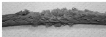
Remplacer également le câble de treuil en cas de fibres étirées ou fondues.
