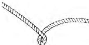
Un câble de treuil métallique déformé ayant été « redressé » est illustré à droite. Malgré le fait qu'il puisse paraître utilisable, le câble a été gravement endommagé de manière irréversible. Il ne peut plus transmettre la charge comme il le faisait avant la déformation. Cesser immédiatement d'utiliser un câble de treuil dans cet état.
