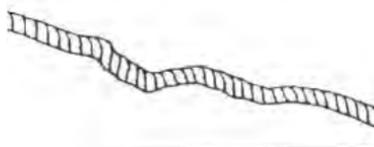
Il faut vérifier un câble de treuil en corde synthétique à la recherche de signe d'effilochage. Remplacer le câble au moindre signe d'effilochage (illustré à droite). Cesser immédiatement d'utiliser un câble de treuil dans cet état.
