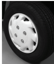
Roue en acier de 12 po, 88 N·m (65 lb·pi)
