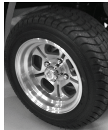
Roue protège- gazon de 12 po, 128 N·m (95 lb·pi)
