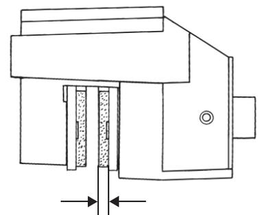
**AVERTISSEMENT !** Ne pas appliquer de graisse WD-40 ou tout autre produit à base de pétrole sur les disques de frein. Ces types de produits sont inflammables et peuvent également réduire la friction entre la plaquette de frein et l'étrier.
