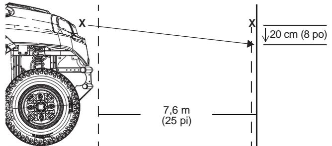
4. Noter la hauteur du phare. La partie la plus intense du faisceau de phare doit se trouver à 20 cm (8 po) au-dessous du repère placé sur le mur. Le conducteur doit être assis sur le siège pendant cette étape.
