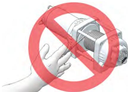
18. Ne jamais relâcher l'embrayage sur le treuil lorsqu'une charge est exercée sur le câble de treuil.
