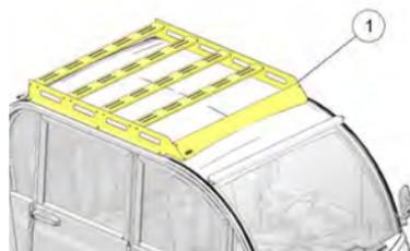
La galerie de toit n'augmente pas la capacité de chargement totale du véhicule. Veiller à ce que le nombre total de passagers et le chargement à l'intérieur et à l'extérieur du véhicule ne dépassent pas le PNBV. Consulter la page 27 et la page 22 pour plus d'informations.
