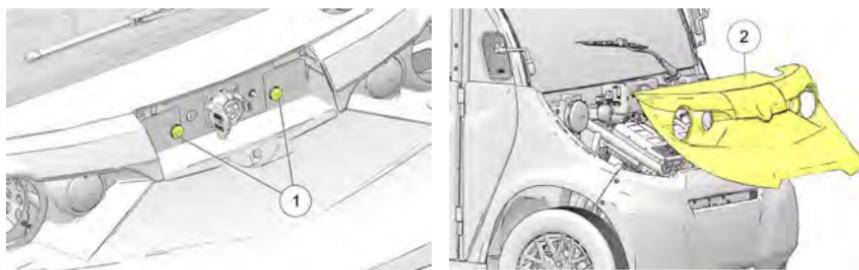
1. Retirer les deux vis du capot ① se trouvant sous la trappe de l'orifice de recharge.
