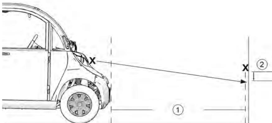
1. Garer le véhicule sur une surface de niveau, avec le phare à environ 7,6 m du mur ①.
