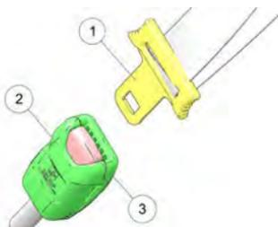
1. Tirer la languette de fixation de la ceinture de sécurité ① vers le bas et en diagonale sur la poitrine vers la boucle ② située sur le rebord intérieur du siège.
