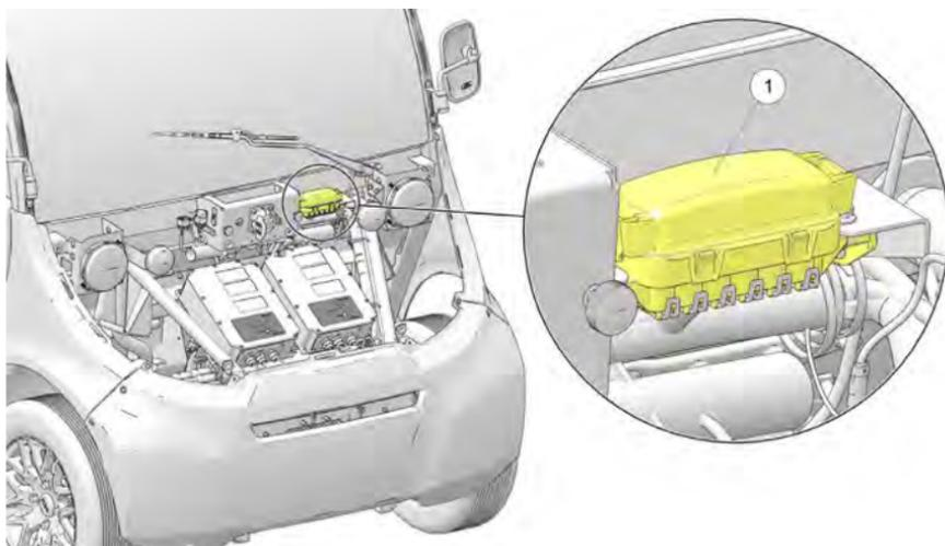
En cas de pannes électriques non reliées aux batteries, un fusible peut nécessiter un remplacement. Localiser et corriger tout court-circuit qui aurait pu causer le fusible sauté, ensuite remplacer le fusible. Consulter un concessionnaire agréé GEM si un relais ou une diode semble nécessiter un remplacement.
