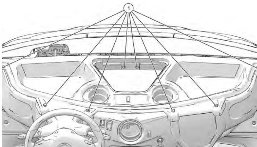
1. Retirer les huit (8) rivets à pression en plastique ① qui retiennent le tableau de bord au châssis. Deux de ces rivets se trouvent à l'intérieur de la boîte à gants.
